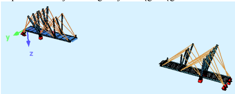
Rys.68. Montaż pomostu sekcji 2-3 i regulacja naciągu cięgien – przypadki LC54 i LC55
